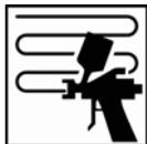
Aplicar una capa media cerrada, dejando un tiempo de evaporación de 5-10 minutos a 20° C. A continuación, aplicar una capa mojada, dejando un tiempo de evaporación de 5-10 minutos a 20° C antes del secado final.
