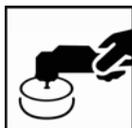
Se puede pulir el polvo y las pequeñas imperfecciones una vez que los tiempos de secado por aire establecidos se hayan cumplido; o después de un secado completo a una temperatura del objeto de 60° C, seguido por enfriamiento hasta alcanzar una temperatura ambiente. Lije cuidadosamente para eliminar todas las partículas de polvo y repare la superficie de acuerdo con las recomendaciones para el pulido.
